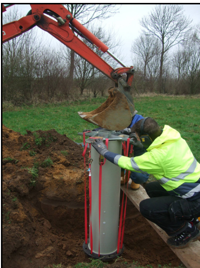
Bild 2: Eindringen eines Lysimeterrohres in den Boden
