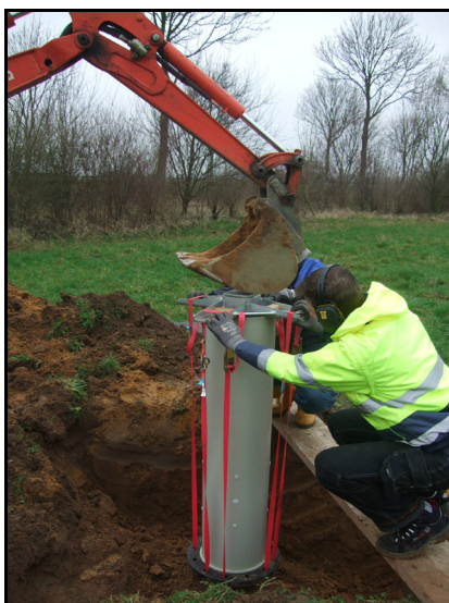
Bild 2: Eindringen eines Lysimeterrohres in den Boden
