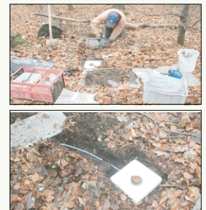
Abb. 2: Einbau einer Kunststoff-Saugplatte unterhalb der Humusaufgabe (Standort: Buchen-Altbestand in BO-Langendreer)
