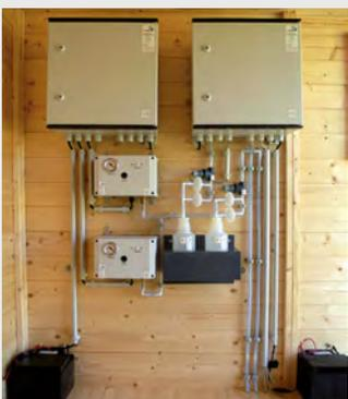
Monitoring des Wasser- und Stoffhaushalts in einem Freilandexperiment mit neun arrondierten Versuchspartzellen.
