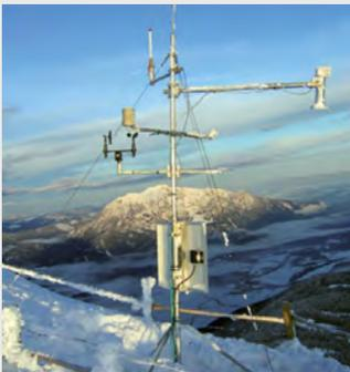
Messung der Schneehöhe auf 1.300 m Höhe durch wartungsarmen Radarsensor, inkl. Datenversand per GPRS, autarke Stromversorgung (Solarstromversorgung).
