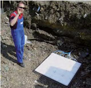
Schadstoffmonitoring in einer Deponie, räumlich aufgelöste Sickerwassergewinnung.
