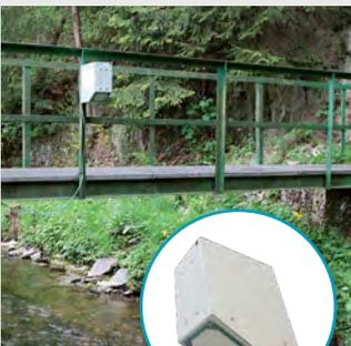
Montage und Kalibrierung des Messinstruments (RQ-30) an der Lahn. Zweimonatige Messkampagne zur Erfassung des Durchflusses, inkl. Datenversand per GPRS, autarke Stromversorgung (Batteriebetrieb).
